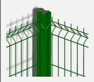
Pour la réalisation d'angles à 90°, utiliser une feuillure à riveter pour les poteaux acier (la riveter plate du poteau avant la pose) - Pour les angles aigus ou obtus, accoler 2 poteaux Aquilon.
